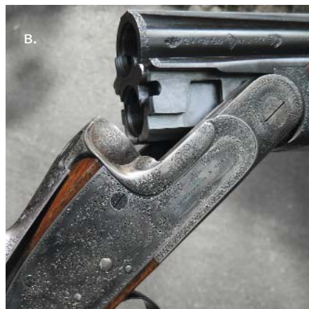
Илл. 6. Впервые эта разновидность консольного шарнира была внедрена в производство лондонской компанией «Джеймс Вудвард и сыновья» (James Woodward & Sons, British Patent № 4986, 1913 г.). Благодаря относительной дешевизне изготовления и сборки система Вудварда завоевала популярность в серийном производстве современных бокфлинтов и штуцеров
